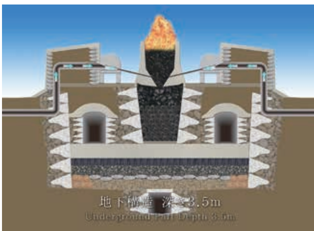
写真1 炉床(地下構造を含む)
