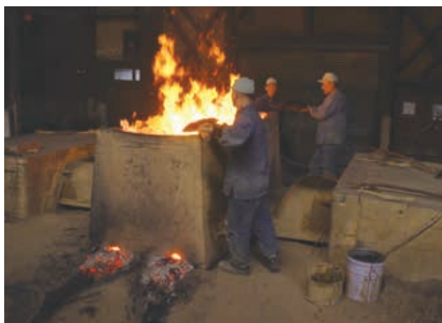
写真3 砂鉄、木炭の投入
